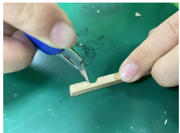
切削時手指要保持距離注意安全，若限於操作能力，可思考如何利用其他方式達到同樣效果？
