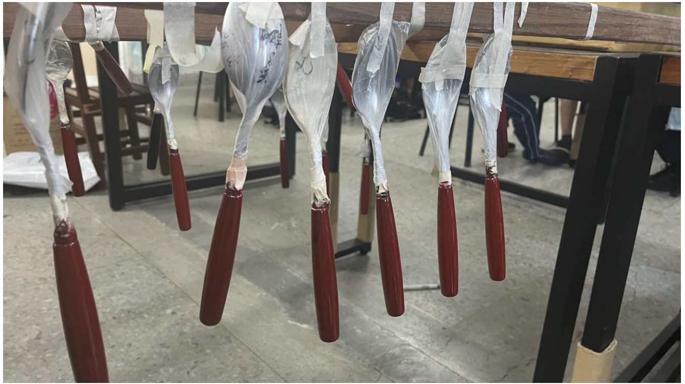
在湯匙木柄的黑色底漆上塗上紅色生漆，垂吊晾乾
