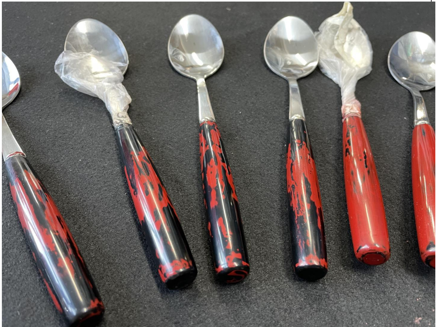
在湯匙木柄的黑色底漆上塗上紅色生漆，垂吊晾乾
