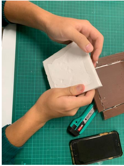
圖24-若比例正常且攪拌均勻，紙黏土很容易即可脫模
