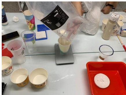
圖25-調製水泥(此次水泥砂:水為150g:40g)
