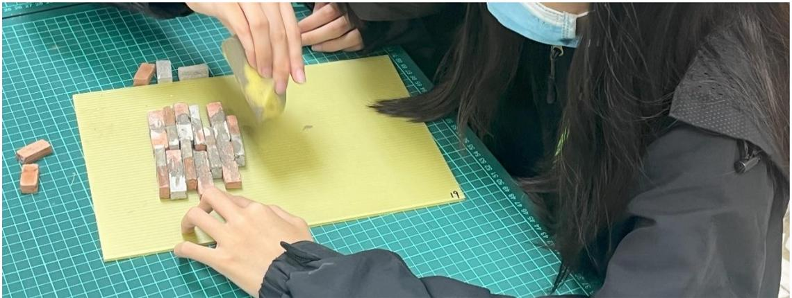
E. 學生操作流程: 加入水泥填縫並用沾水凝乾的海棉擦拭，或平塗產生不同質感牆面。
