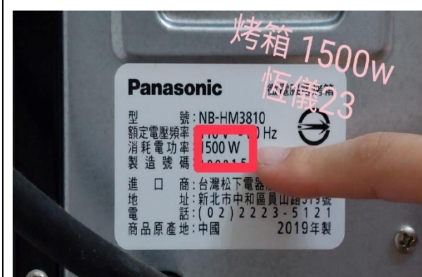
1120519 學生上傳第 12 期第三版”尋找家中電器的功率”，發現烤箱 1500W 耗電
