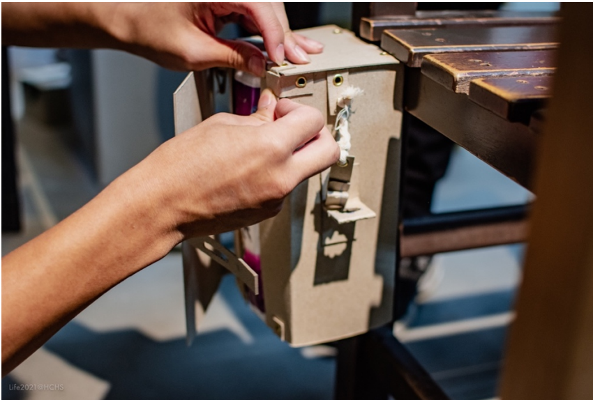
面紙盒製作過程與各種紙張與棉繩、金屬圈、橡皮筋等材料間的構造設計
