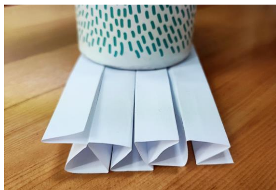
設計百摺形式後測試承重力
