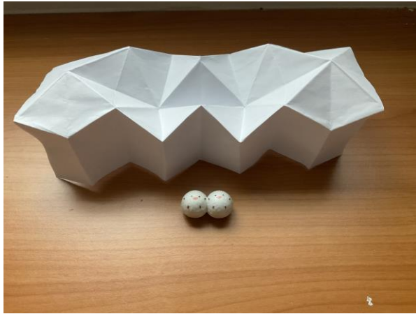
折板框架可形成具支撐力的頂棚
