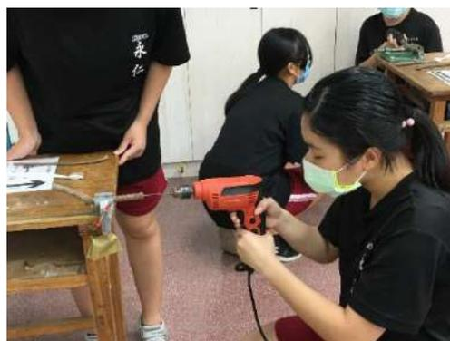
使用電鑽挖出一個筆心能放入的洞
