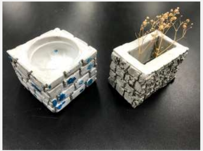
自製水泥容器質感與色彩試驗 (灰/白水泥)
