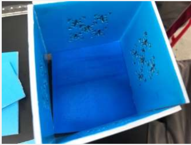
自製水泥容器質感試驗(珍珠板外模)
