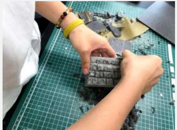
自製水泥容器質感試驗(珍珠板外模)
