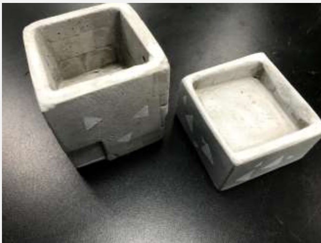
自製水泥容器質感與色彩試驗 (型版套染)
