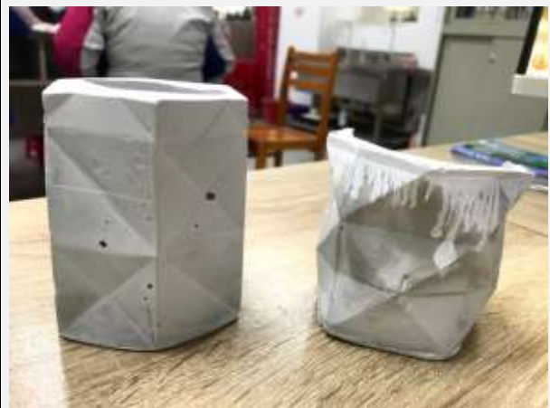
自製水泥容器質感與色彩試驗 (運用 pp 片紙摺原理製作外模)
