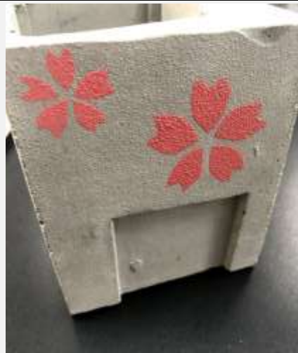
水泥容器質感與色彩試驗 (型版套染)
