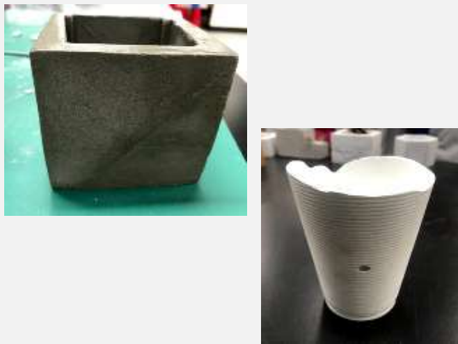
自製水泥容器質感試驗 (運用生活器皿灌模)
