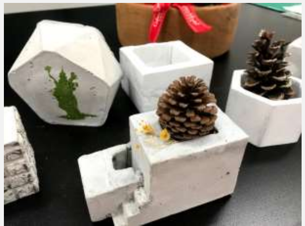
自製水泥容器質感與色彩試驗 (水泥與沙比例調製產生不同質感)
