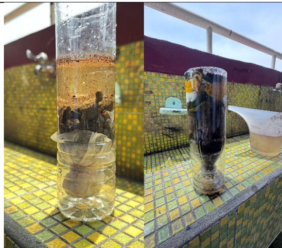
圖說: 分組製作寶特瓶簡易濾水器
