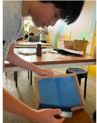
圖三 | 操作感光塗布，進行絹印製版。
