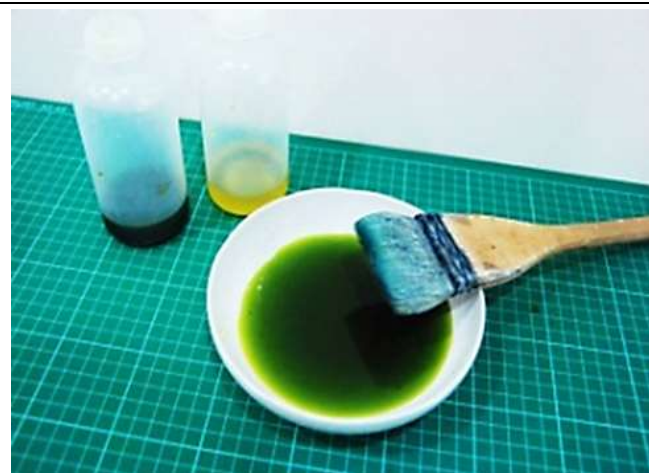
鐵氰化鉀(赤血塩)、檸檬酸鐵銨、混合藥水調製
